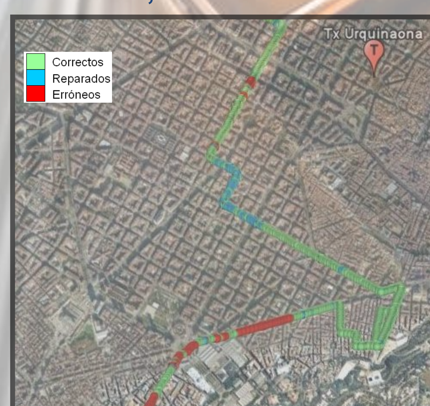
Red terrestre, 2 transmisores Medidas de capa física
